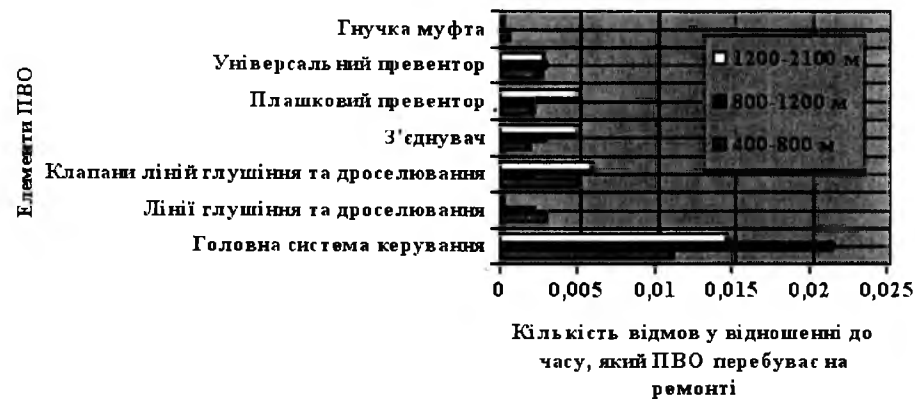
Рис.2. Діаграма залежності виникнення відмов елементів ПВО від глибини акваторії
